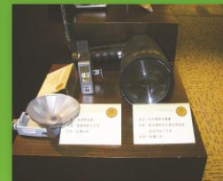
圖右紅外線閃光燈罩(配合傳統閃光燈夜間蒐證照相工作用,民國75年)
